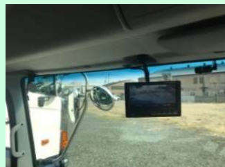
車内、車外記録及びバックカメラの装着
