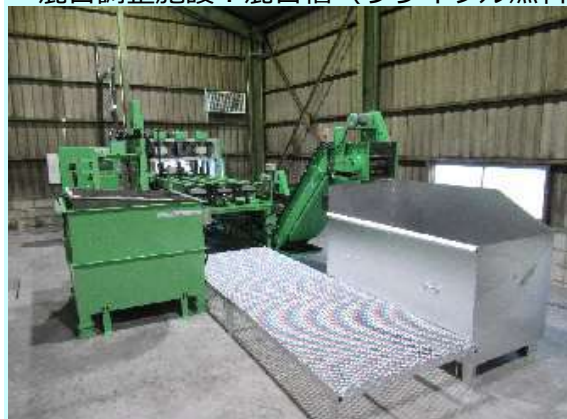
オイルフィルター自動切断装置 （岡山県経営革新計画 優秀賞受賞）
