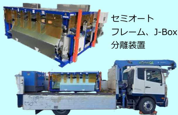
固定式兼移動式による太陽光パネル処理 （廃棄物発生現場での太陽光パネル産廃処理が可能）
